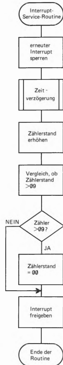
Bild S 77.1 Der Programmablaufplan der Interrupt-Service-Routine. Das eingetragene Zeitverzögerungsprogramm ist nicht extra aufgeführt. Es ist mit dem auf Seite S 68 gezeigten Unterprogramm ZEIT nahezu identisch.
