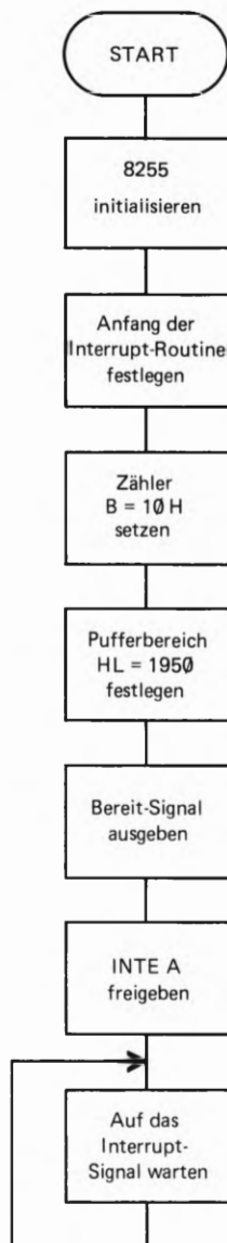
Bild S92.1 Der Programmablaufplan für das Hauptprogramm. Das Programm leistet die Initialisierungsarbeit für den 8255. Ansonsten wartet das Programm auf einen eintreffenden Interrupt.
