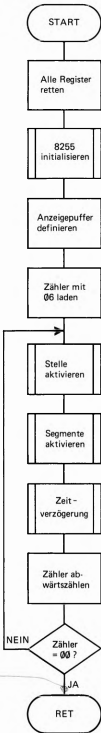
Bild S78.1 Der Programmablaufplan zur Ansteuerung der Anzeige. Programmstart ist die Adresse 1800H.
