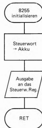
Bild S 79.1 Das Unterprogramm initialisiert den Ein-/Ausgabebaustein.
