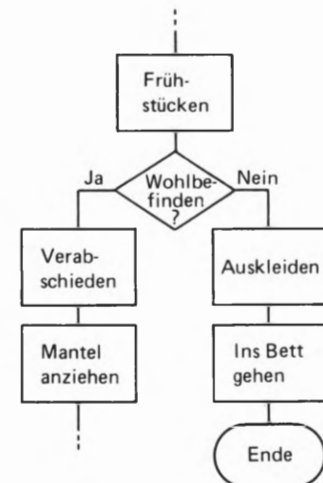
Bild S5.1 Bei einer Verzweigung kann der eine Programmzweig statt zu einer Schleife auch zum Ende des Programms führen.
