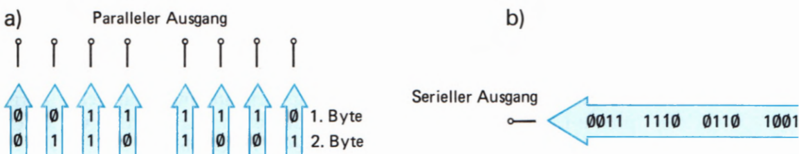
Bild H57.1 a) Für den Bit-parallelen, Byte-seriellen Datentransport werden acht Leitungen benötigt. b) Beim Bit-seriellen, Byte-seriellen Datentransport genügt eine Leitung. In beiden Fällen kommt eine Leitung für das Bezugspotential hinzu.
