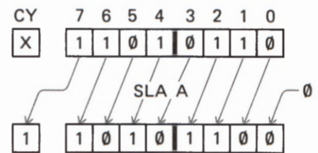
Bild S101.1 Durch die Funktion des hier dargestellten Schiebe-Befehls SLA A wird das Byte D6 im Akkumulator in das Byte AC verwandelt. Das Bit Nr.7 wird an die CY-Bit-Stelle geschoben.
