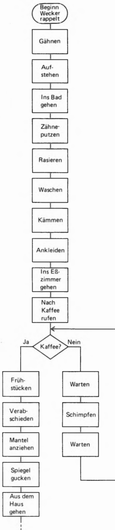
Bild S4.1 In diesem Programmablaufplan tritt in Abhängigkeit von äußeren Umständen eine Verzweigung auf.
