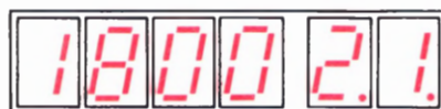
Bild H8.2 Bei der Daten-Eingabe erscheinen Dezimalpunkte an den rechten beiden Stellen der Anzeige.
