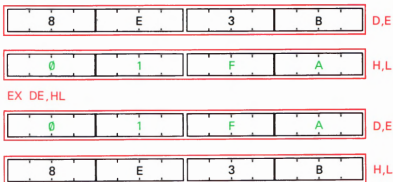
Bild H38.1 Mit dem Befehl EX DE,HL werden die Inhalte der Registerpaare DE und HL miteinander vertauscht.
