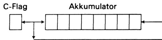
Das links stehende bit des Akkumulators wird in das C-Flag **und** gleichzeitig in das rechte bit des Akkumulators geschoben. Dieser Befehl hat folgendes Format:
