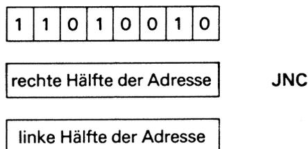
Die weiteren 6 bedingten Sprungbefehle haben alle das gleiche Format (3-Byte-Befehle). Wir werden deshalb nur noch die verschiedenen Codes angeben.
