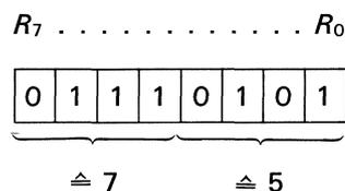
Um jeden einzelnen Melder isolieren zu können, wird ein Zeiger benötigt, d.h. ein Register, in dem **eine** 1 enthalten ist, die über alle Stellen verschoben wird. Durch eine AND-Verknüpfung dieser 1 mit den Melderzuständen kann jeder einzelne Melder auf seinen Zustand geprüft werden.
