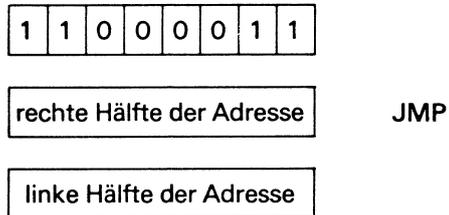
So bedeutet z.B. der Sprungbefehl JMP 0 4 3 0, daß der Befehlszähler auf die absolute Adresse 0 4 3 0 bzw. auf die relative Adresse 3 0 springt.
