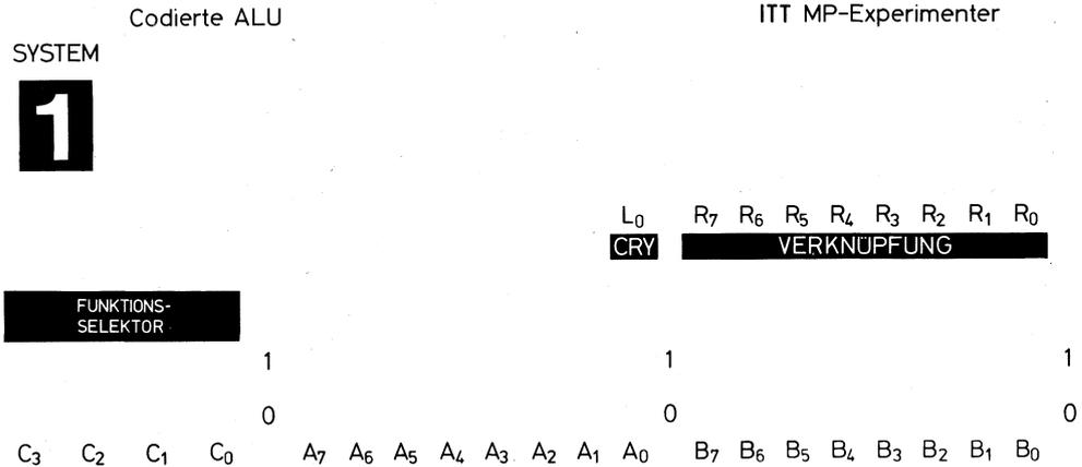
Für dieses Experiment ist eine 8-bit-Version der in Bild 3.3.3 dargestellten codierten ALU simuliert worden. Die Funktionen  $U_3$  bis  $U_0$  in Tab. 3.3.1 werden mit den Schaltern  $C_3$  bis  $C_0$  festgelegt. Diese Tabelle ist auch auf der Karte „Codierte ALU“ zu finden.
