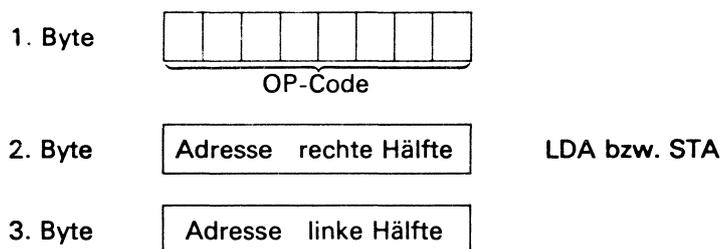
Mit dem Befehl STA wird der Inhalt des Akkumulators unter der im 2. und 3. Byte angegebenen
