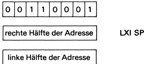
Soll beispielsweise der Stack-Bereich bei der Adresse 0 4 A 0 beginnen, so muß mit dem Befehl LXI SP der Stack-Pointer 0 4 A 1 gesetzt werden. Ein im Programm nachfolgender PUSH D-Befehl würde dann den Inhalt des D-Registers nach Adresse 0 4 A 0 und den Inhalt des E-Registers in Adresse 0 4 9 F bringen.
