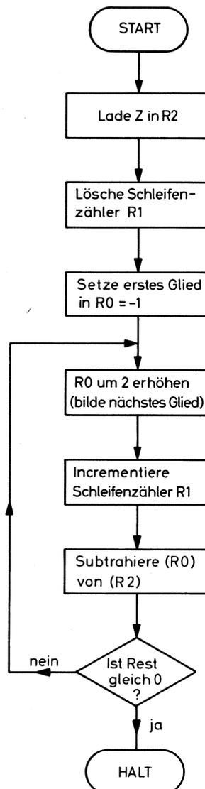
2. Das erste Programm entspricht nicht dem in Bild 5.1.1.1 dargestellten Format einer Schleife, da der Hauptteil der Schleife vor und nach der Entscheidung liegt. Der Programmteil Bildung des nächsten Gliedes (R0) + 2 wird **erstmalig** nach der Entscheidung ausgeführt. Wird z.B. Z = 1 gewählt, wird dieser Teil nicht durchlaufen. Bei der zweiten Version wird (R0) + 2 bereits beim ersten Schleifendurchlauf ausgeführt. Formal entspricht dieses Programm dem Schleifenformat in Bild 5.1.1.1.
